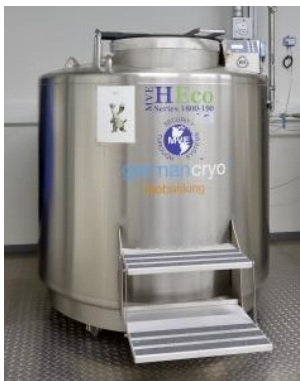
Probenlagerung in Stickstofftanks (-196°C)
