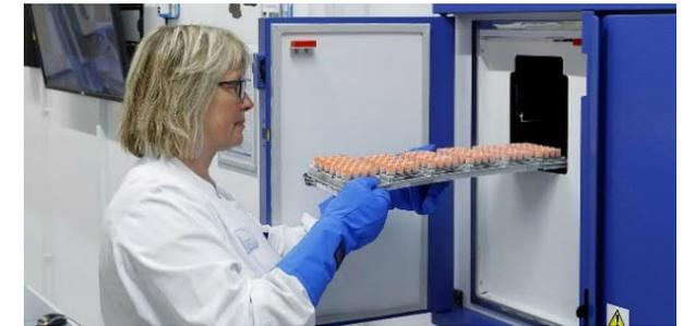
Probenlagerung bei -80°C im automatisierten Lagerroboter
